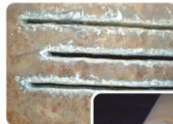
Зразок розрізу заготовки з СЧ-20, 60 мм завтовшки
