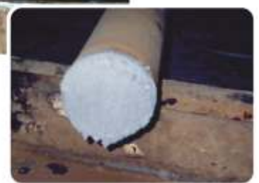
Зразок розрізу прокату 150 мм зі сталі 12Х18Н10Т
